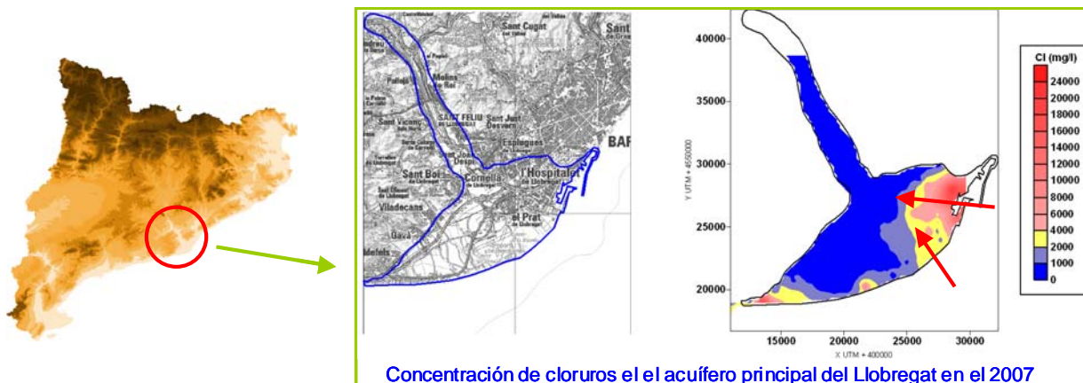
Figura. 1. Concentración de cloruros en el acuífero principal del Delta del Llobregat en el año 2007. Se observa la intrusión marina que afecta al acuífero por diversos puntos.
