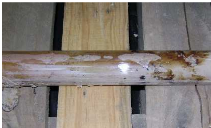
Fotografia 1 – Fase livre móvel em amostra de material de perfuração
