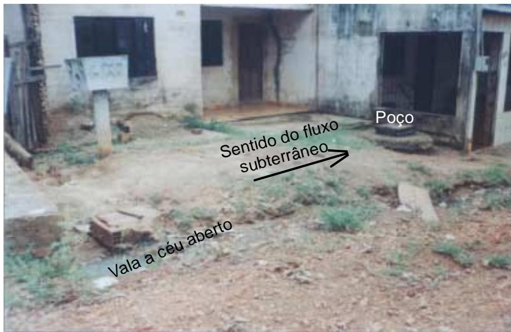
Figura 11- Poço 3 situado no beco Fernando de Noronha, onde se percebe as precárias condições de higiene local, com a vala escoando a céu aberto e o poço localizado a jusante do fluxo.
