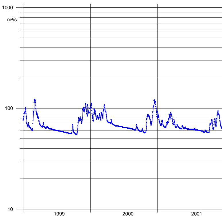
Figura 5 – Hidrograma do rio Formoso na estação Gatos 1999– 2001 (vazão x tempo)
