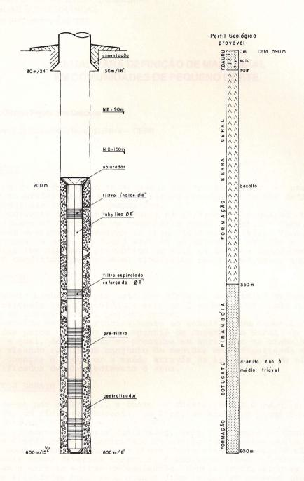
PROJETO ESQUEMÁTICO DE POÇO TUBULAR PROFUNDO DE GUARIBA - SP
