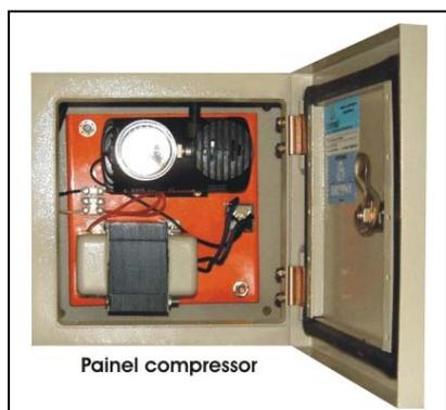
**Nível:** a medição de nível é feita pelo princípio de borbulhamento, utilizando-se um compressor de ar e uma mangueira. Para evitar o uso contínuo do compressor, a tomada de pressão é feita com o compressor desligado e a intervalos regulares o compressor é ligado por um tempo pré-programado e a seguir a medida da pressão da coluna de água na mangueira é retomada.
