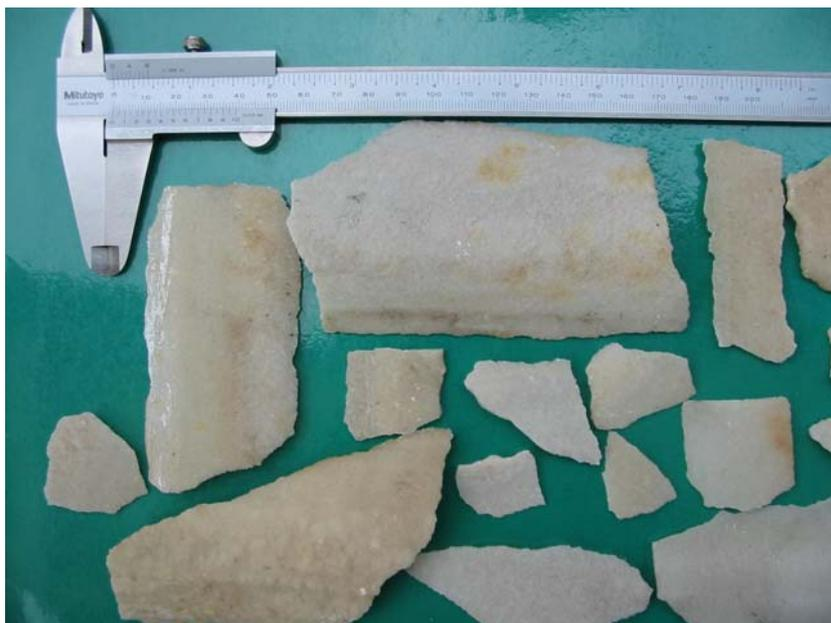
Figura 5. Detalhe dos fragmentos de incrustação retirados da parte externa da tubulação de adução.
