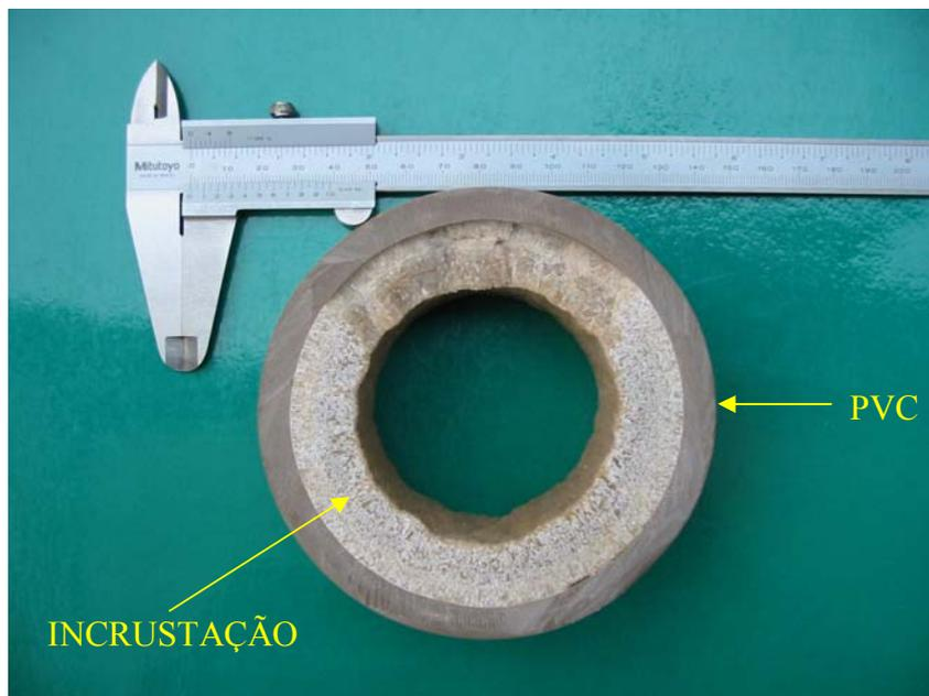
Figura 2. Detalhe de tubulação incrustada por carbonato de cálcio.
