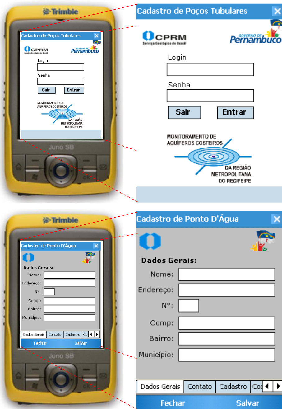
Figura 2. Telas de exemplo do aplicativo de cadastro de ponto d'água para recenseamento dos poços, integrado o GPS Juno SB da Trimble.
