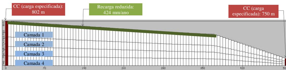
Figura 9. Malha em diferenças finitas e condições de contorno associadas ao modelo do aquífero abaixo do aterro sanitário de Uberlândia. Exagero vertical: 2x.
