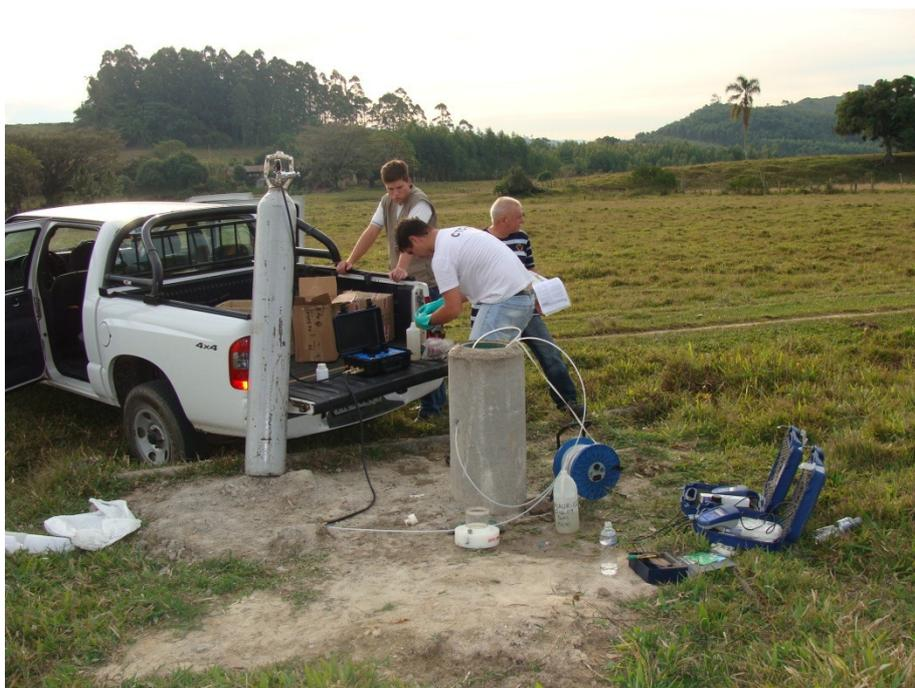
**Figura 7. Detalhe de uma amostragem realizada no poço de monitorização PMAPUR01, na bacia do rio Urussanga.**
