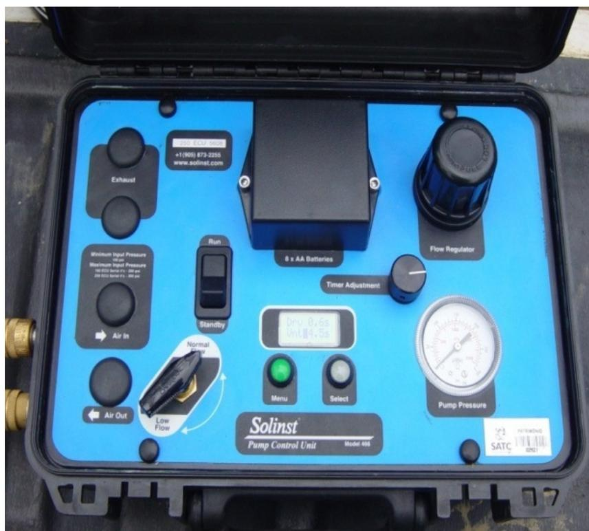
**Figura 5 – Detalhe do controlador eletrônico de fluxo.**
