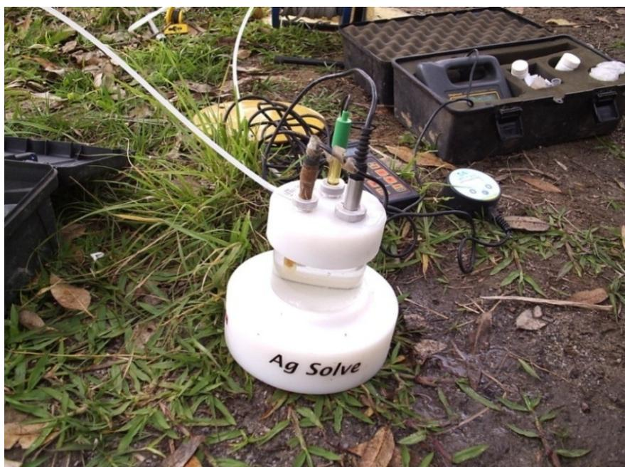
**Figura 6 – Detalhe da célula de fluxo.**
