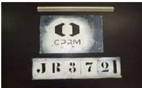
**Figura 2.** Matrizes metálicas para pintura da sigla da CPRM e sigla do poço, no corpo do mesmo.
