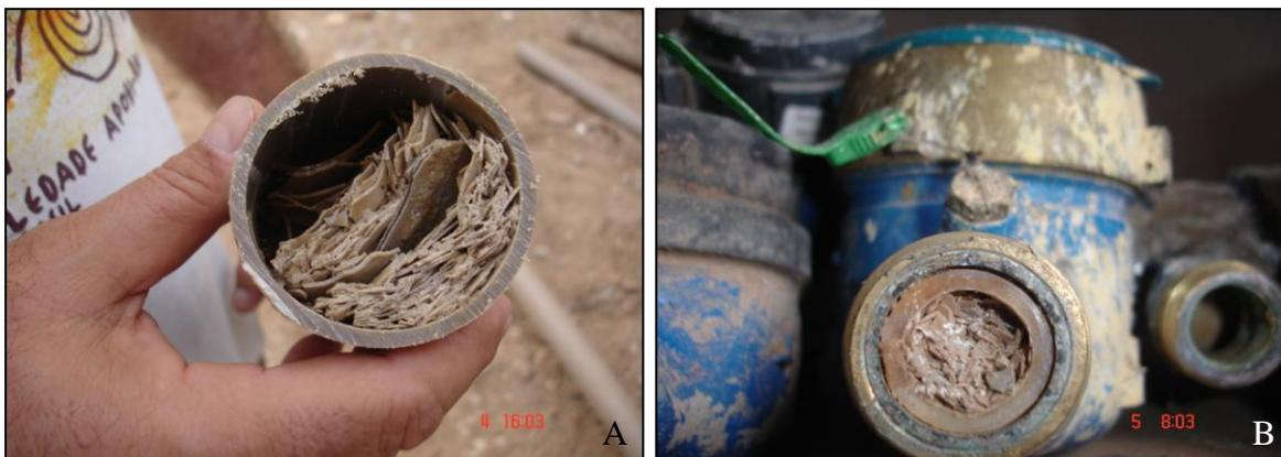
Fotos 01 e 02 – A) Precipitação do cálcio em forma de lâminas no interior das tubulações.
