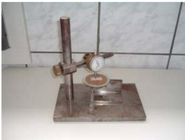
Figura 6: Extensômetro Utilizado para Medição da Espessura do Reboco.
