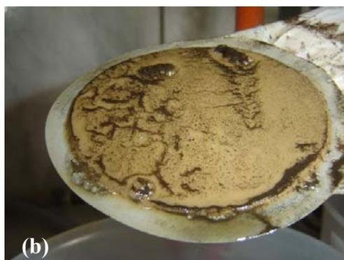
Figura 21. (a) Reboeco Após 3 h e (b) Reboeco Após 6 h na Solução 3,4% de Spersene.
