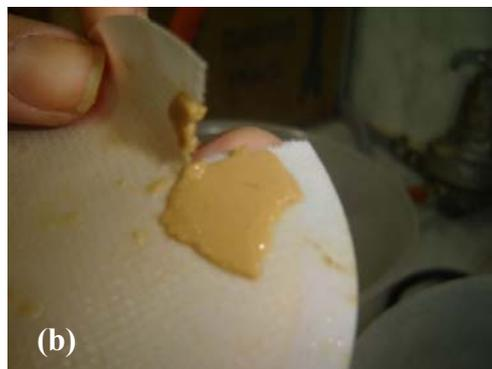
Figura 22. (a) Reboeco Após 1 h e (b) Reboeco Após 6h na Solução de Hipoclorito de Sódio.
