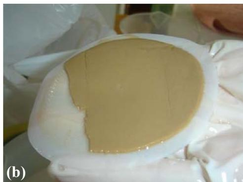
Figura 19. (a) Reboeco Inicial (b) Reboeco Após 6 h na Solução de 3,4% de Hexa T.
