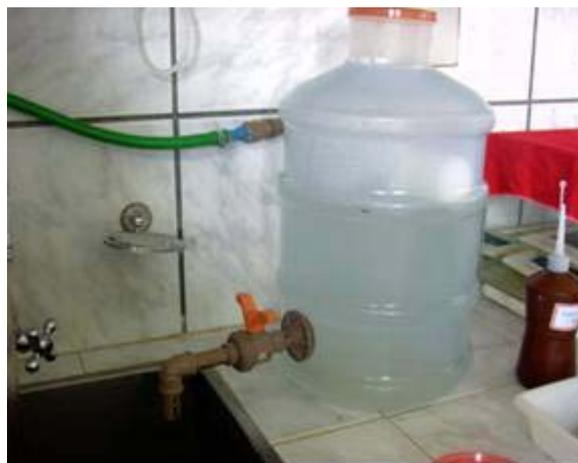
Figura 4. Recipiente de Nível Constante com Vazão Regulável.
