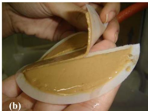
Figura 20. (a) Reboeco Inicial (b) Reboeco Após 6 h na Solução de 3,4% de Hexa.
