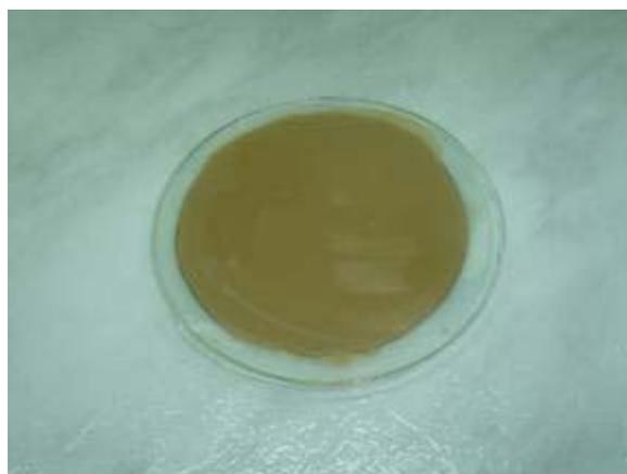
Figura 5. Lâminas de Vidro e Papel de Filtro de Mesmo Diâmetro.
