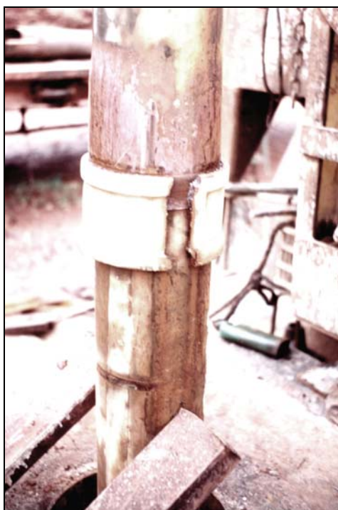
Foto 11. Afundamento das roscas devido ao choque durante a queda.
