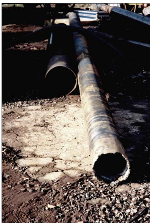
Foto 12. Pescador com sapata, utilizado para pescaria de madeira e materiais diversos.
