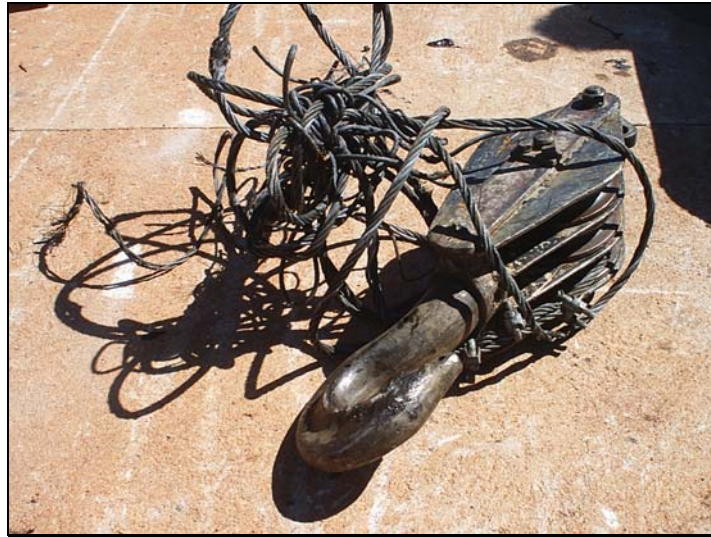
Foto 6. Catarina e cabos de aço retirados do poço.
