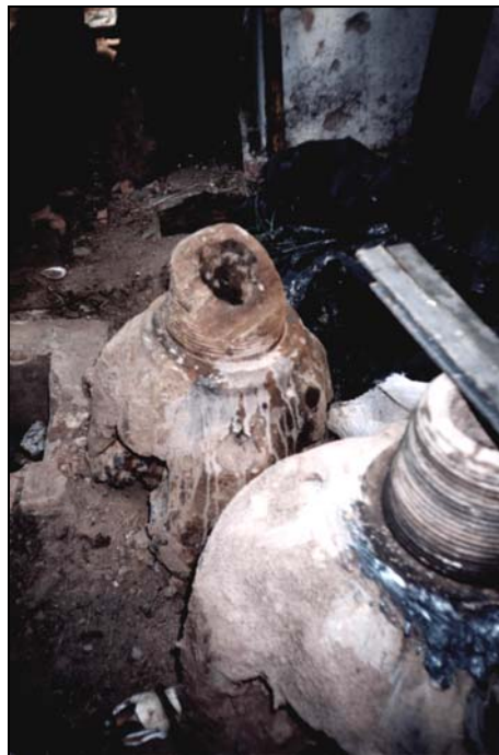
Foto 23. Boca tricônica retirada do poço após a pescaria.
