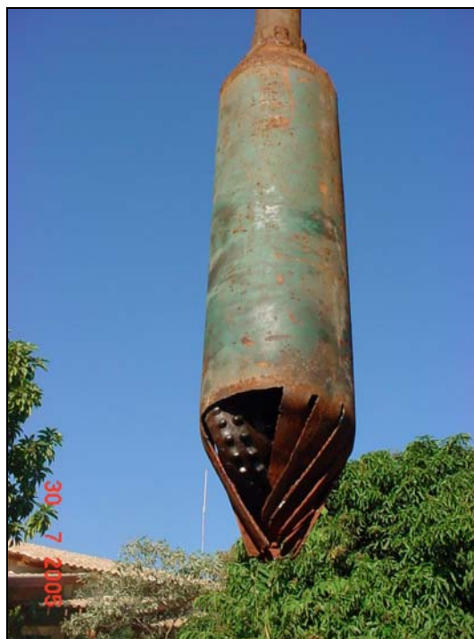
Foto 25. Pescador tipo cesta utilizado para a pescaria do cone.
