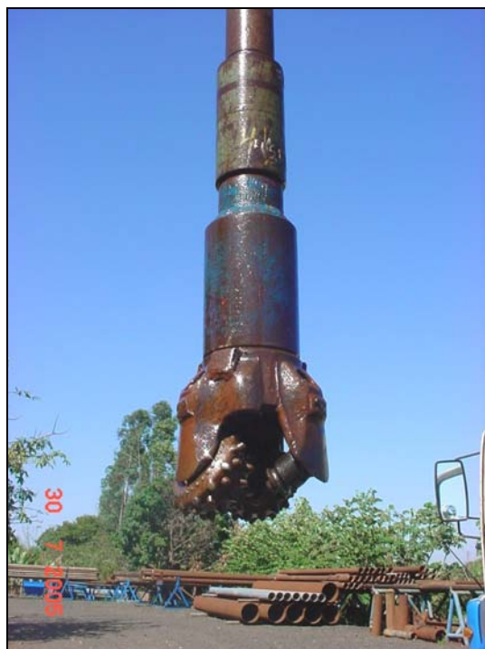
Foto 24. Broca tricônica sendo retirada do poço sem um cone.
