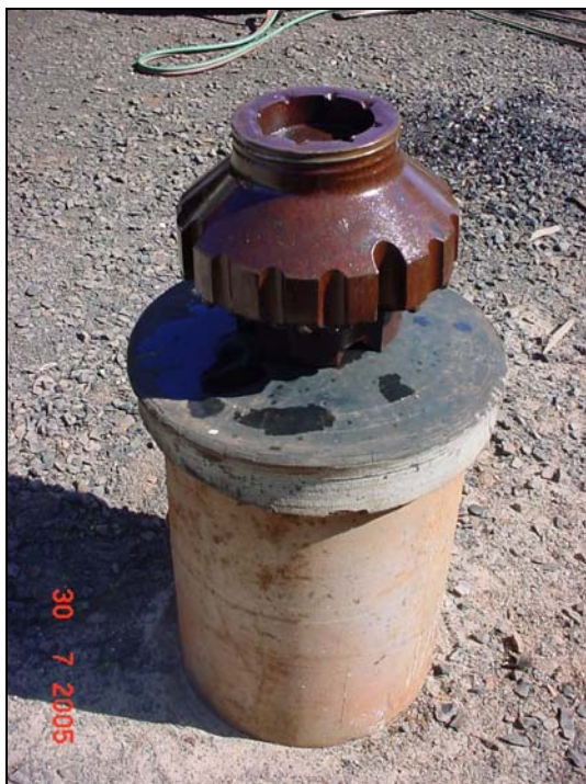
Foto 26. Bit alargador retirado do poço durante a pescaria.
