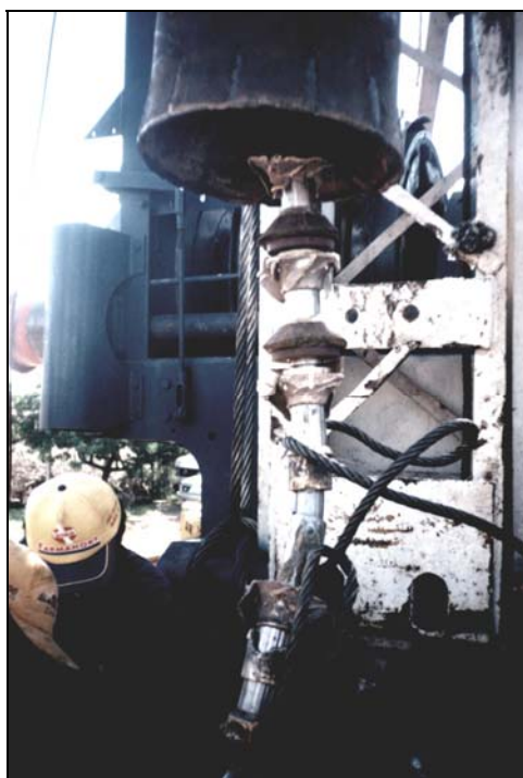
Foto 18. Pescador com garra com os rotores e carcaças partidas com a queda.
