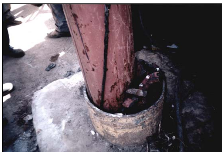
Foto 21. Fragmentos dos rotores do bombeador.
