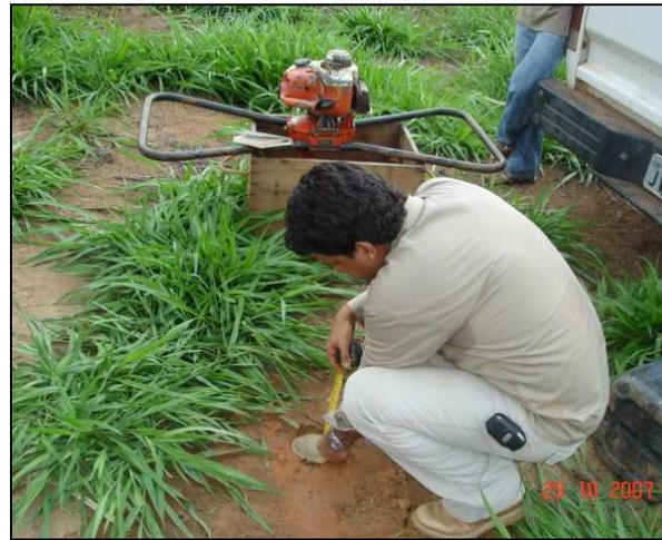
Figura 4 – Medição do nível da água para determinação da permeabilidade (K) dos sedimentos constituintes da zona não saturada.
