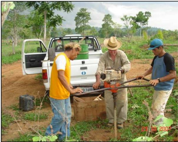
Figura 3 - Realização de sondagem a trado para coleta de sedimentos.
