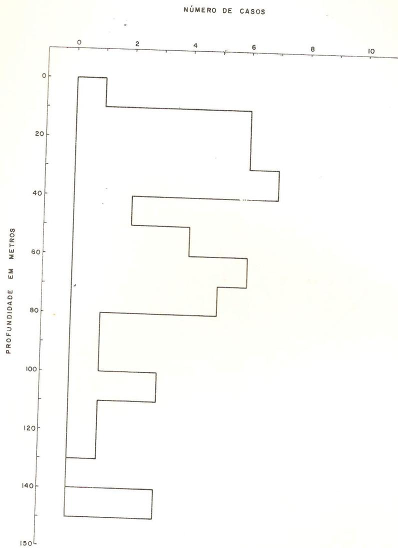
FIG. -7- DISTRIBUIÇÃO DA PROFUNDIDADE DE ORIGEM D'ÁGUA BASEADA NA CONCENTRAÇÃO DE TRÍTIU.
