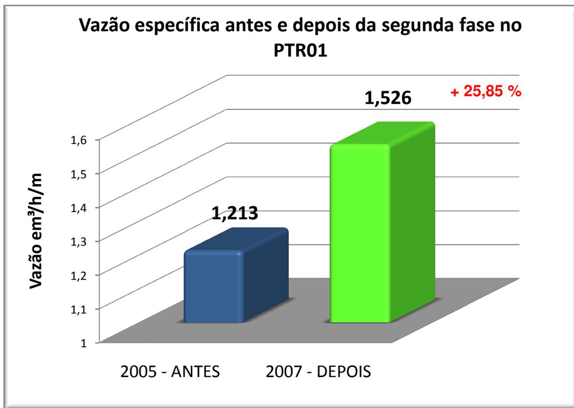
**Gráfico 2.** Resultados do incremento na **vazão específica no PTR-01** após as operações.
