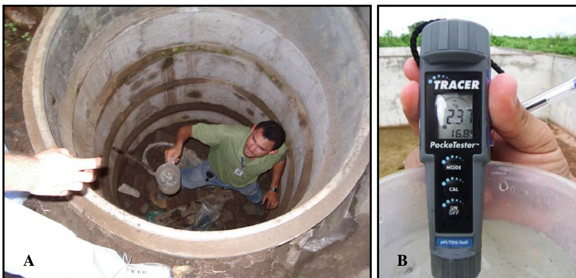
Figura 03 A e B – Processo de coleta de amostra de água e sonda Tracer utilizada no monitoramento qualitativo.
