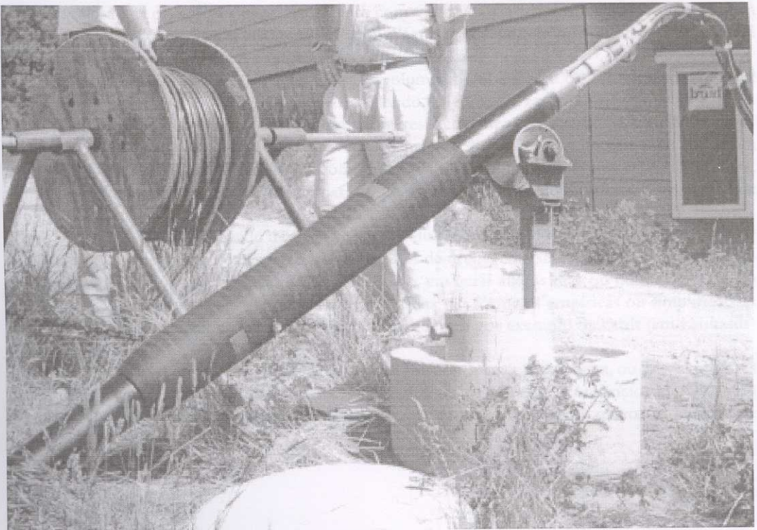
Figura 10 – Detalhe de um obturador de borracha usado para estimulação. Foto do autor.
