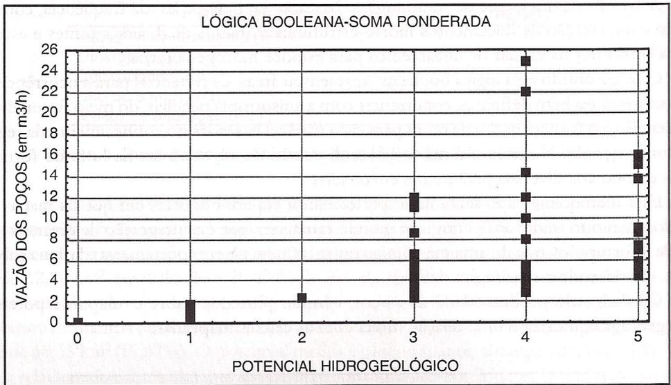
Figura 9. Relação entre o potencial obtido por lógica booleana-soma-ponderada e a vazão dos poços.
