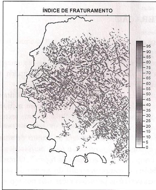
Figura 5. Índice de fraturamento obtido a partir da integração das grades de comprimento, freqüência e intersecção de lineamentos morfo-estruturais (Freitas, 1998).
