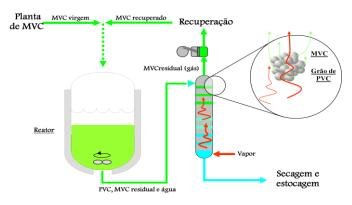
FIGURA 1: Detalhe da separação por stripping.
