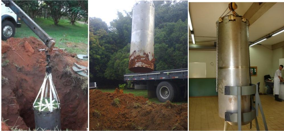
**Figura 02:** Detalhamento da extração do monólito a), transporte até o laboratório b) içamento para instalação no suporte no laboratório
