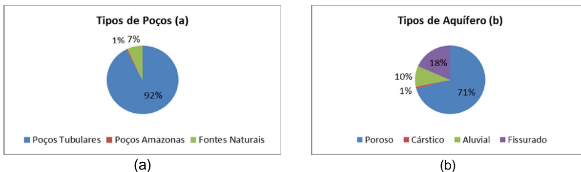
Figura 1. a) Tipos de poços na região do Cariri usados na exploração de água subterrânea e b) Tipos de aquífero onde se localizam os poços de exploração de água.
