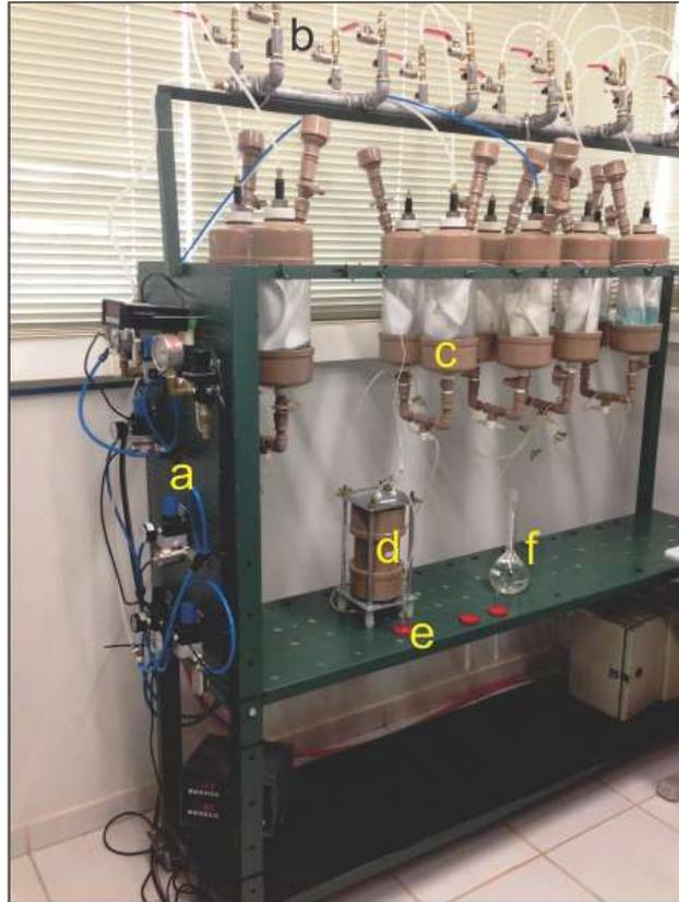
**Figura 4** - Sistema do permeâmetro de carga constante. (a) painel de controle do ar comprimido; (b) sistema de distribuição de ar; (c) pares de reservatório com balão interno; (d) permeâmetro; (e) proveta graduada para coleta de água percolada; (f) termômetro.
