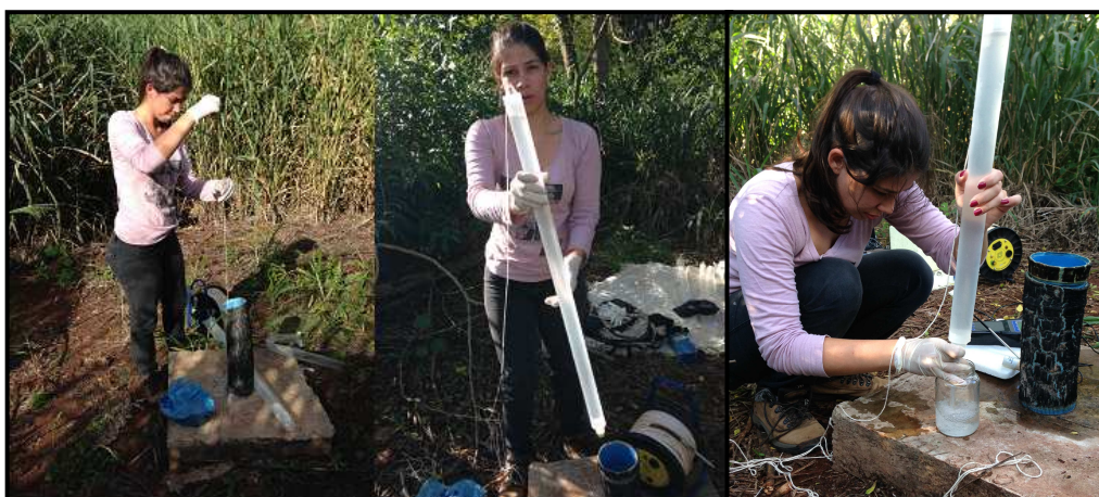
Figura 4 – Purgamento e coleta das amostras de águas dos poços de monitoramento.
