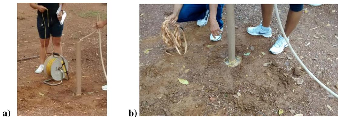
**Figura 5.** a) Saturação do furo. b) Formação do anel de umidade.
