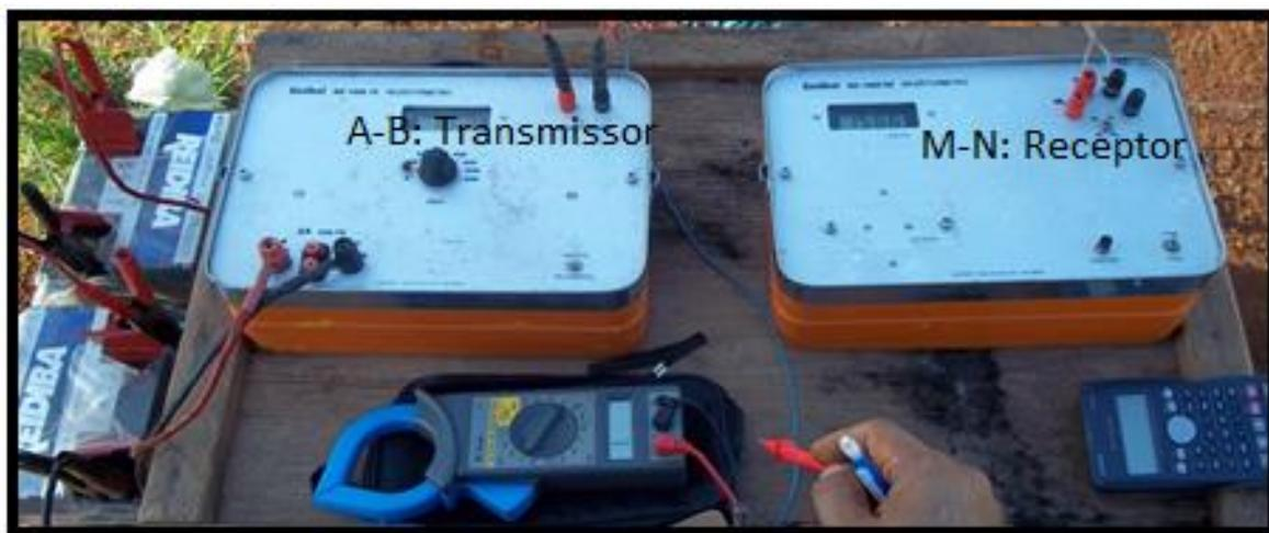
Figura 3: Resistivímetro GEOTEST RD 1000 TX.
