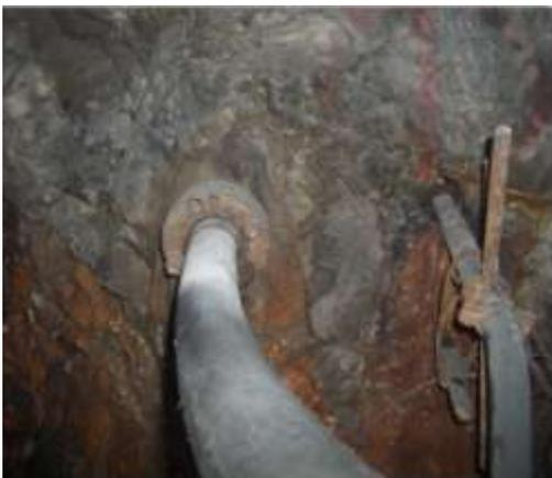
Figura 7: Captação de água nos furos de sonda
