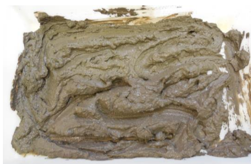
Figura 1 – Borra preparada com solo, água subterrânea e reagente.
